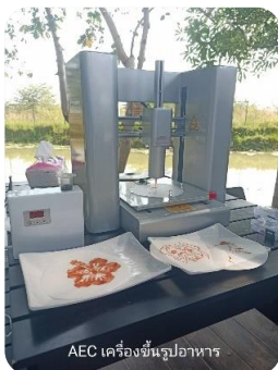
7. เครื่องขึ้นรูปอาหารจากของเหลวเพื่อสร้างสรรค์อาหารและเครื่องตีอัตโนมัติ
