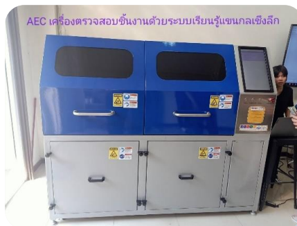
8. เครื่องตรวจสอบชิ้นงานอัตโนมัติด้วยกล้องอัจฉริยะระบบการเรียนรู้เชิงลึก
