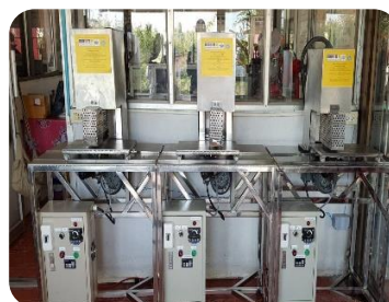
7. เครื่องทุบหมูสำหรับผลิตภัณฑ์หมู ทุบ แบบกึ่งอัตโนมัติ
