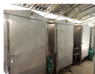
11. ตู้อบแผงกระเบื้องรองไข่ไก่ใช้พลังงาน ความร้อนจากเตาแก๊สอินฟราเรด
