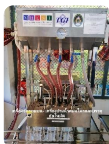
14. เครื่องปรุงผสมน้ำสมุนไพรและ น้ำผลไม้บรรจุขวดพร้อมดื่มขนาด เล็กแบบกึ่งอัตโนมัติ
